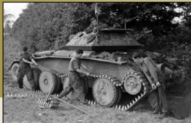
▼ De bemanning van een Covenanter tank repareert een rupsband.
